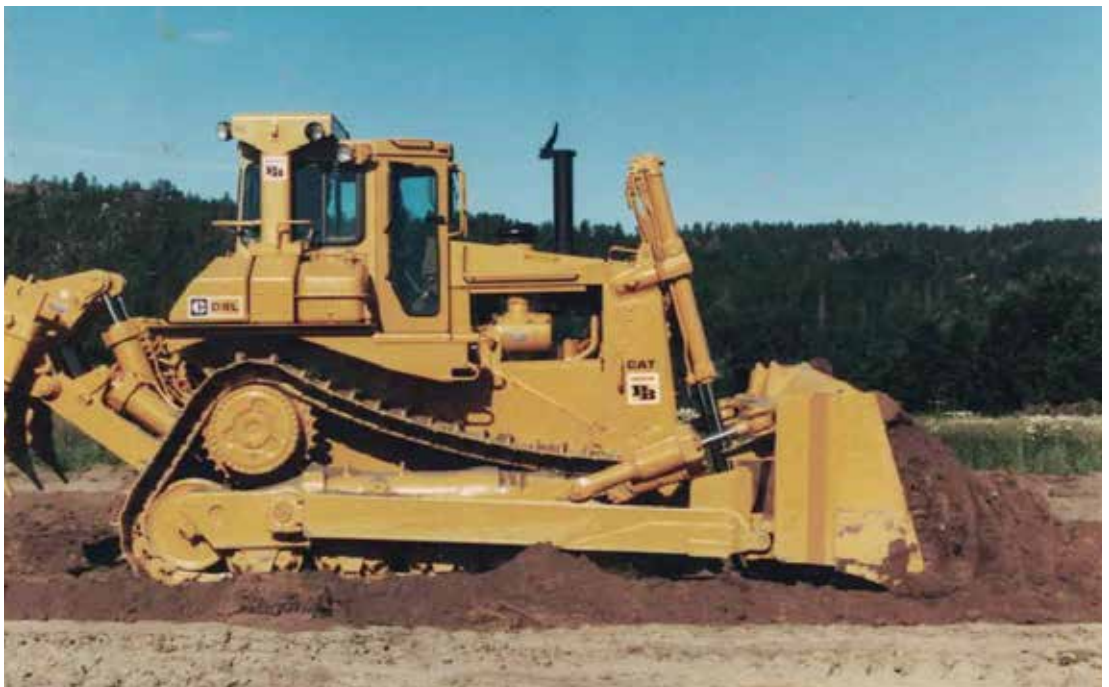
En av de store og moderne bulldoserne. Legg merke til ripperne bak. Foto: Anders Lefsaker.
